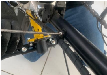
Etapa 12: Retirar os parafusos de fixação dos cabos elétricos na coluna de direção. Utilizar a chave Allen 5mm.
