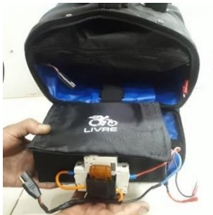
Passo 3 - Insira a bateria na bolsa.
