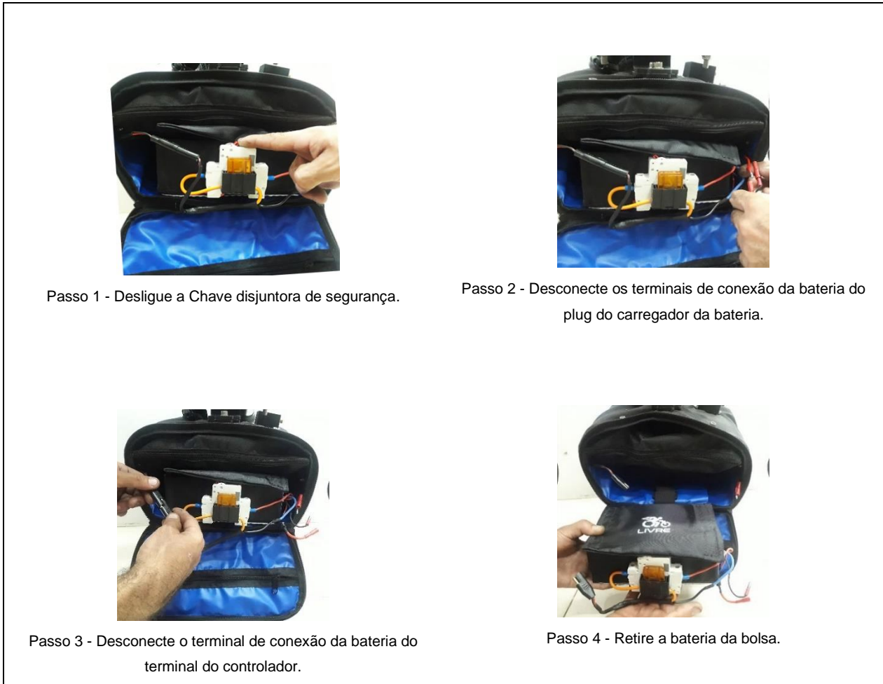
Figura 9 - Sequência para desacoplamento da bateria.
