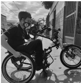
Figura 51 - Subida de calçadas com o KIT LIVRE® com auxílio de propulsão na roda traseira – * Imagem meramente ilustrativa.
