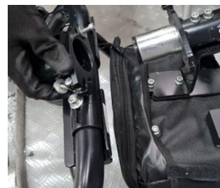
Etapa 6: Remover suporte de acoplamento.
