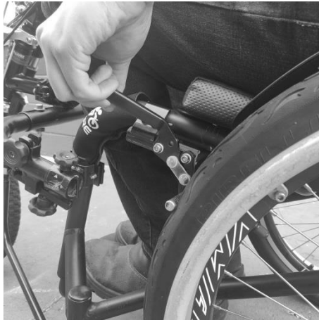
Figura 41 - Destravamento dos freios de estacionamento da cadeira de rodas – * Imagem meramente ilustrativa.
