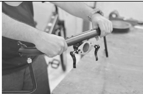
Passo 5: Inserir a curva lado direito (3) no centro do suporte (8).
