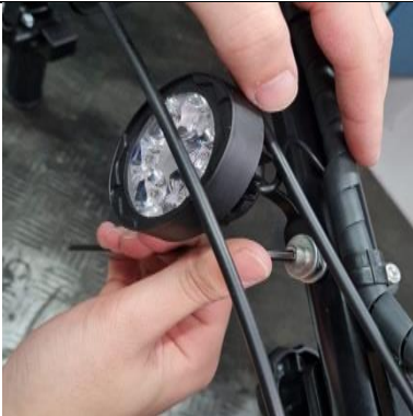
Etapa 9: Desafixar farol integrado. Utilizar chave Allen 4mm.
