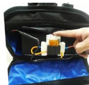
Passo 6 - Ligue a chave disjuntora de segurança.
