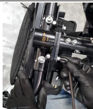
Etapa 4: Destrovar o pino de bloqueio. Utilizar Chave Allen 5mm.
