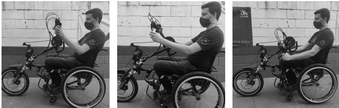
Figura 62 – Movimento de propulsão do dispositivo.
