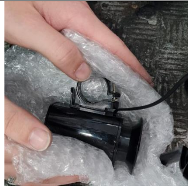
Etapa 8: Envolver buzina em plástico bolha.
