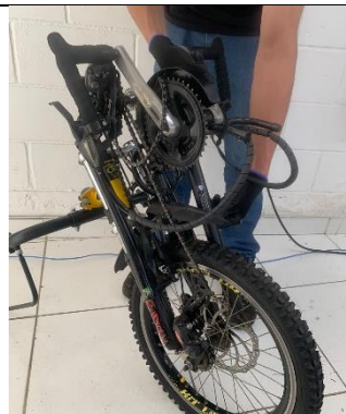
Etapa 13: Dobrar a coluna de direção para frente, mantendo a sua parte inferior alinhado à esquerda da roda dianteira.
