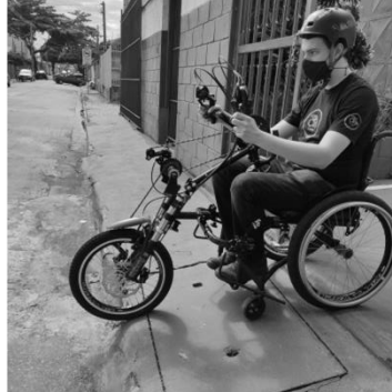
Figura 53 - Descida de calçadas com o KIT LIVRE® (2ª posição) – * Imagem meramente ilustrativa.
